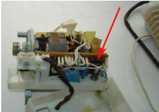
Плата регулятора находится в корпусе блока двигателя на рамке. Индуктивный датчик скорости отсутствует (в отличие от могилевского прототипа).
