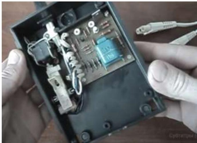
По внешнему виду отличия «ЭПОС-А» от «ЭПОС» только в том, что разъем на блоке двигателя 3-х контактный (а не 5-и контактный).
