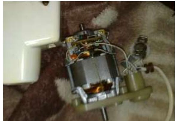
Блок двигателя разобранный
